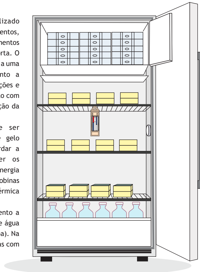
Figura 1. Organização correta do refrigerador. Observe que o congelador está preenchido com bobinas de gelo e a gaveta inferior com garrafas contendo água. O termômetro de mercúrio está posicionado ao centro, entre a primeira e a segunda prateleiras.
